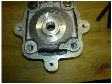
Nachdem jetzt beide Löcher auf 10mm aufgebohrt wurden, nehmen wir ein Alurohr mit 10mm
