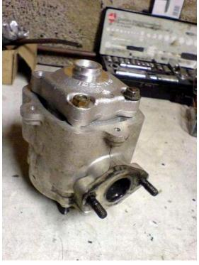
Auf diesem Bild sind die verschraubten Stehbolzen zu sehen.
