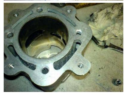
Hier zu sehen im aufgesteckten Zustand. Eine solche Zentrierung ist vor allem sehr zu empfehlen, wenn man einen ausgedrehten Zylinderkopf fährt, da dort der Kolben bei OT bis in den Zylinderkopf und dessen Brennraum hineinläuft. Ist ja logisch, das wenn dann der Zylinderkopf schief montiert ist, der Kolben ziemlich schnell ableben
