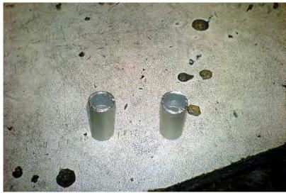
Diese zwei Hülsen werden nun in die gebohrten Löcher des Zylinderkopfes eingesetzt. Wer möchte, kann die Hülsen mit ein bisschen Dichtmasse einsetzen, dann fallen sie nicht so leicht raus.
